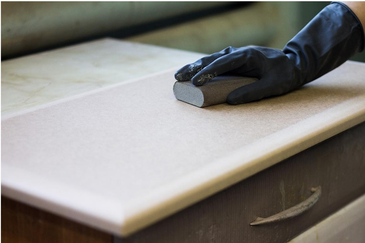
Перед облицовыванием детали следует подготовить к нанесению клея следующим образом:
